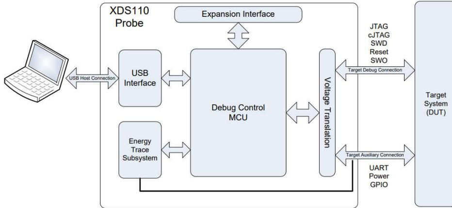
Figure 5-4. XDS110 Probe High-Level Block Diagram
