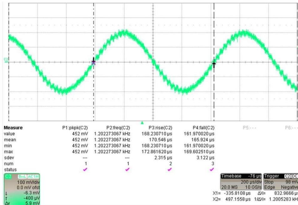
图 14. 1.2-kHz HART Wave Signal
