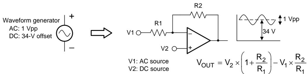
图 19. Difference Amplifier Circuit
