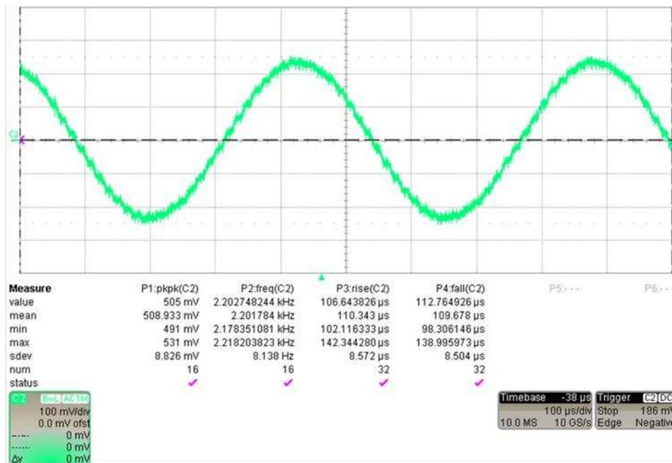
图 15. 2.2-kHz HART Wave Signal
