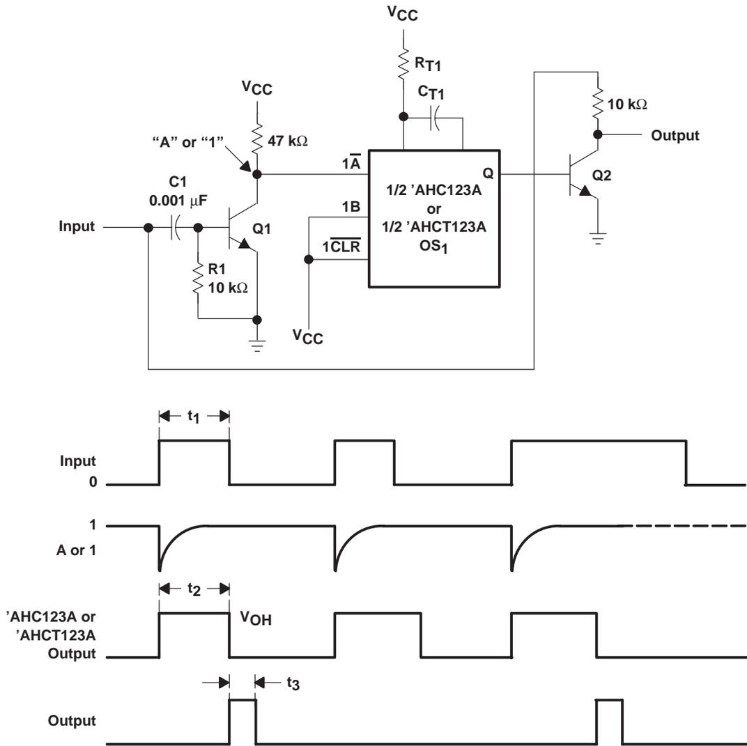
Figure 13. Pulse-Duration Detector
