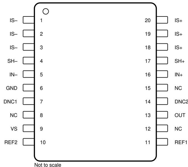
**Figure 4-1. Pin Diagram**
