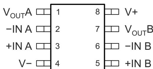
**Figure 3-1. Pin Diagram**
