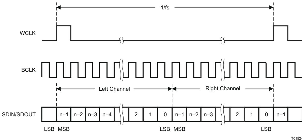
**FIG 10-6. DSP Serial Data Bus Mode Operation**
