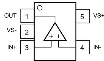
図 5-2. DBV Package, 5-Pin SOT-23 (Top View)
