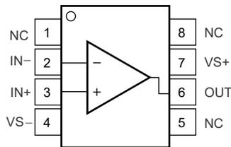
図 5-1. D Package, 8-Pin SOIC (Top View)
