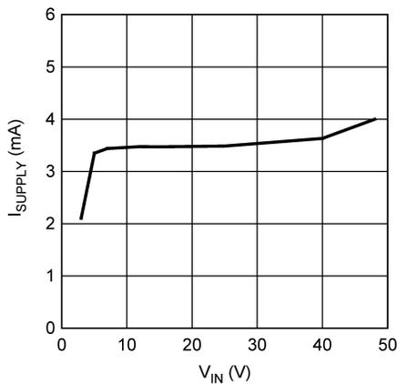
图 5-9. I<sub>SUPPLY</sub> vs. Input Voltage (Switching)
