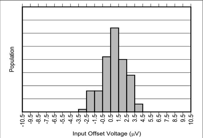
図 6-2. INA296A2-Q1 の入力オフセットの製造分布
