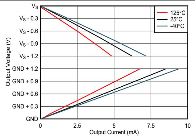
図 6-22. 出力電圧と出力電流との関係
