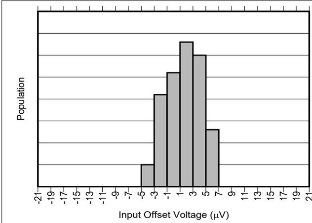
図 6-1. INA296A1-Q1 の入力オフセットの製造分布
