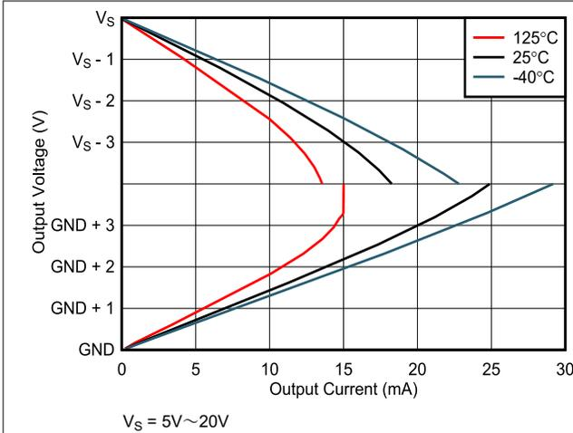
図 6-23. 出力電圧と出力電流との関係
