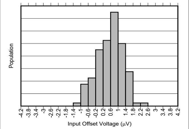
図 6-4. INA296A5-Q1 の入力オフセットの製造分布
