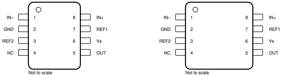
図 5-1. INA296x-Q1 : DDF パッケージ 8 ピン SOT-23 上面図
