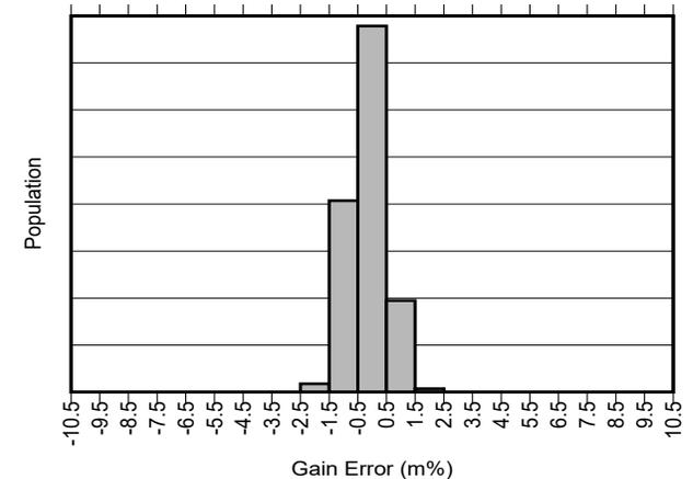
図 6-10. INA296A1-Q1、INA296A2-Q1、INA296A3-Q1 のゲイン誤差の製造分布
