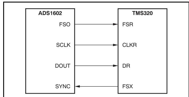
**Figure 54. ADS1602—TMS320 Interface Connection**
